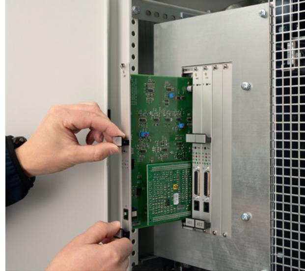
Die USV-Anlage ist mit diskreten Steuerungs- und Überwachungsbaugruppen (Einschubtechnik mit Frontsignalisierung) ausgestattet.
