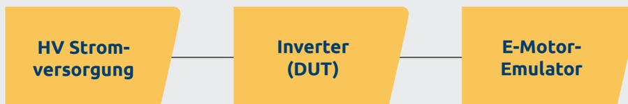
Mit einer Spannung von 600 bis 1500 V DC liefert unsere HV-Stromversorgung die nötige Energie für Ihre Hochspannungsanwendungen.
