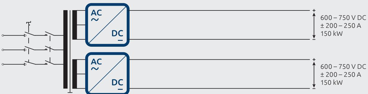
Der GR-3880-1500-300 verfügt über zwei galvanisch getrennte Gleichrichter, die den Anforderungen entsprechend flexibel verschaltet werden können.
