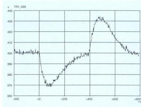
Dynamik-Verhalten der Gleichspannung bei Belastung/Entlastung mit 100 % Last
