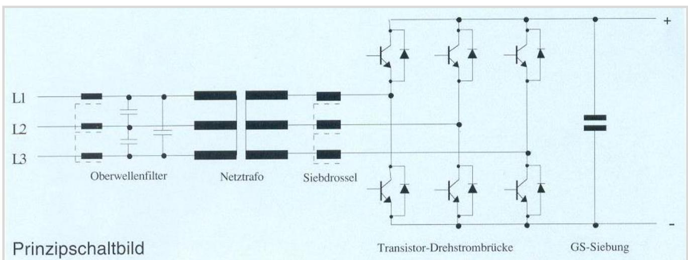
Durch unsere moderne Steuerung mit PWM - Gleichrichter (IGBT) wird über den ganzen Leistungsbereich eine sehr gute Regeldynamik erreicht.
